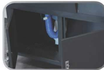
지분집진장치 작업자의 안전을 위해 작업시 발생할 수 있는 오염물질을 모아두는 장치
