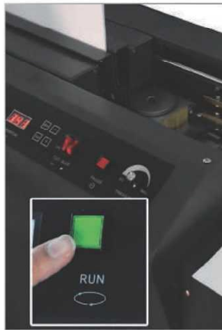
RUN 버튼 조작 이동차가 지나가며 제본을 시작 본드를 바르고 압착판쪽으로 이동
